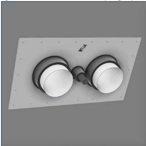
Figuur 9: Plaatsen kanalen en afwerken sparingen optie
